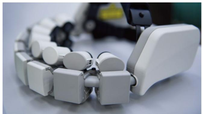
頭部に装着し、前頭葉に向けて光を照射。光の反射を利用して脳活動を測定する(NIRS)
